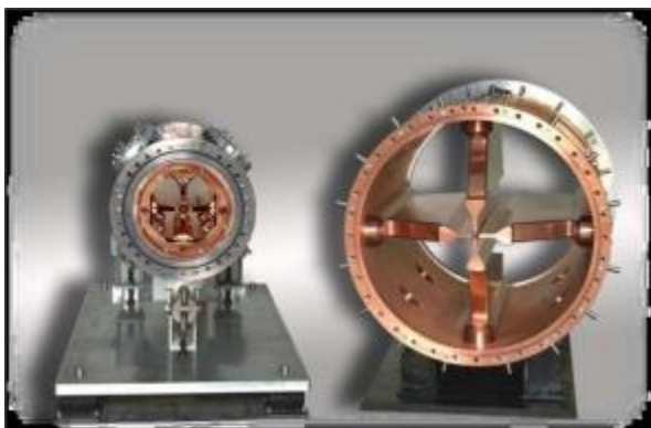
Figure 44 : Section de 2 types de cavité RFQ et cavité complète et intégrée sur sa ligne (RFQ SPIRAL 2 au GANIL)
